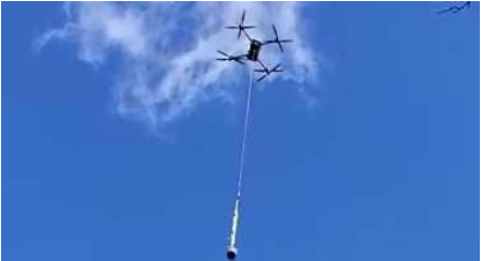
写真-5 空中線を輸送するドローン
